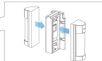
ATTENTION: Le support T ne peut pas être utilisé pour 2 détecteurs hyperfréquence. DAM-DAM, DAM-RDAM, RDAM-RDAM.
